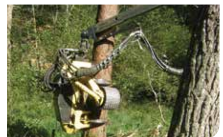
Flexible d'alimentation d'une tête d'abatteuse
